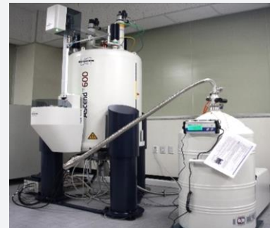
NMR 600Mhz-Prodigy (Nuclear Magnetic Resonance) 고분자구조 분석장비
